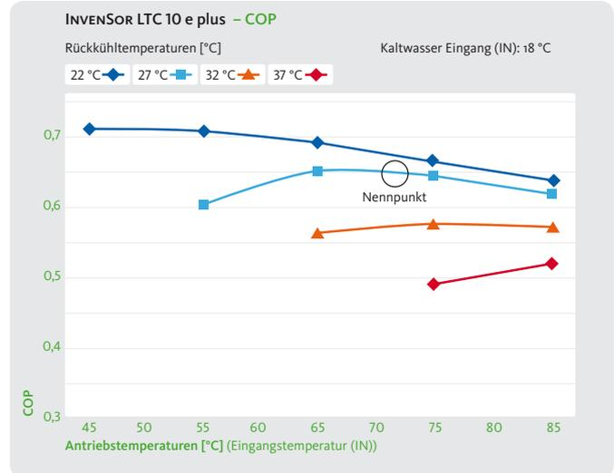
Leistung und COP nach Rückkühltemperatur über Antriebstemperatur (mit aktiviertem High-Efficiency-Modus)
