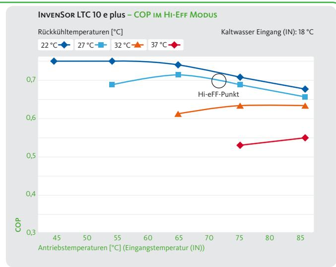
Leistung und COP nach Antriebstemperatur über Kaltwassertemperatur (Nennwerte)
